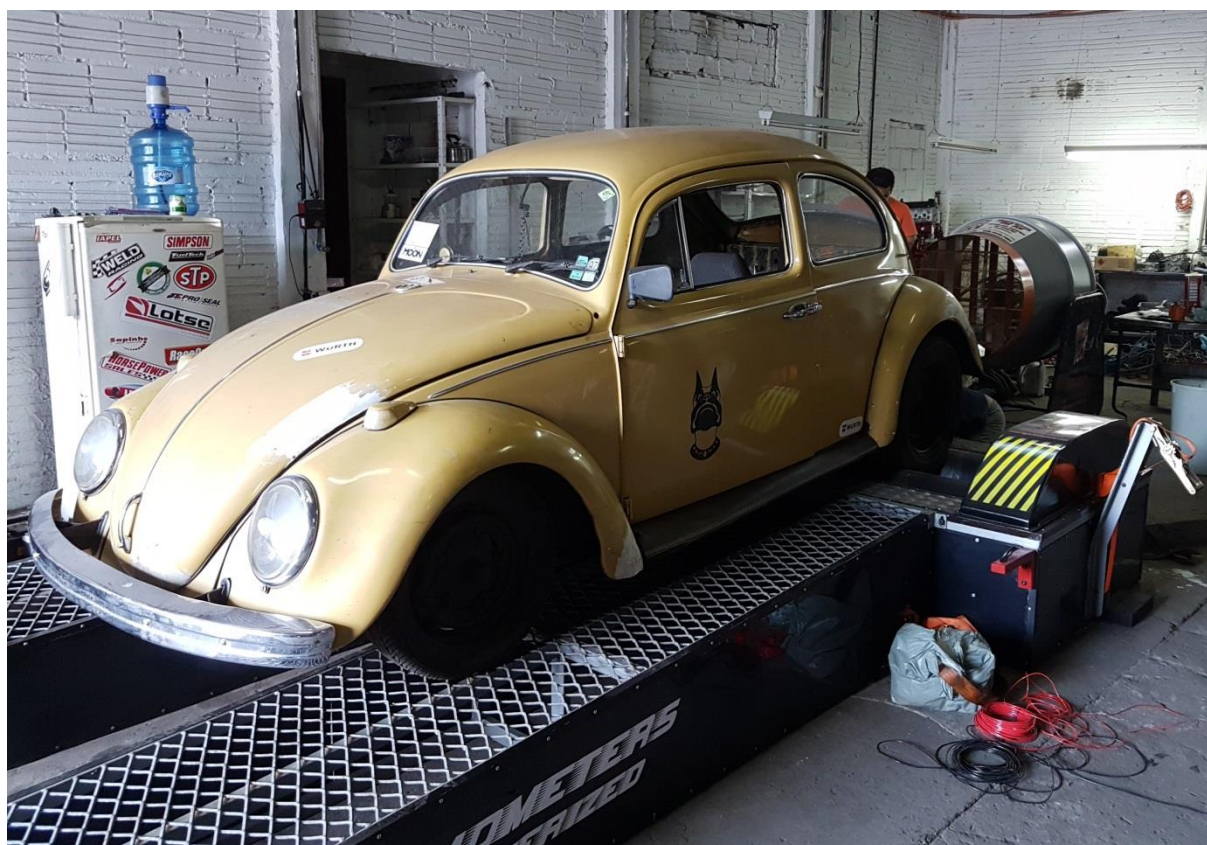
Figura 27 – Vw “Fusca” posicionado no dinamômetro para testado.
