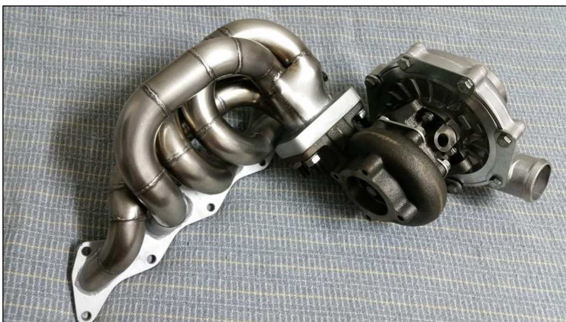
Figura 19 – Exemplo de coletor de escape para motor com turbocompressor.
