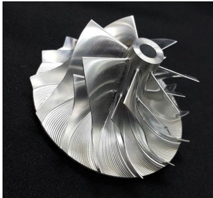
Figura 17 – Exemplo de rotor do compressor.
