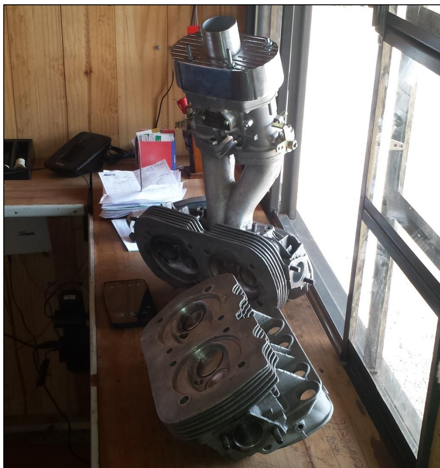
Figura 24 – Cabeçote com as válvulas de maior diâmetro.
